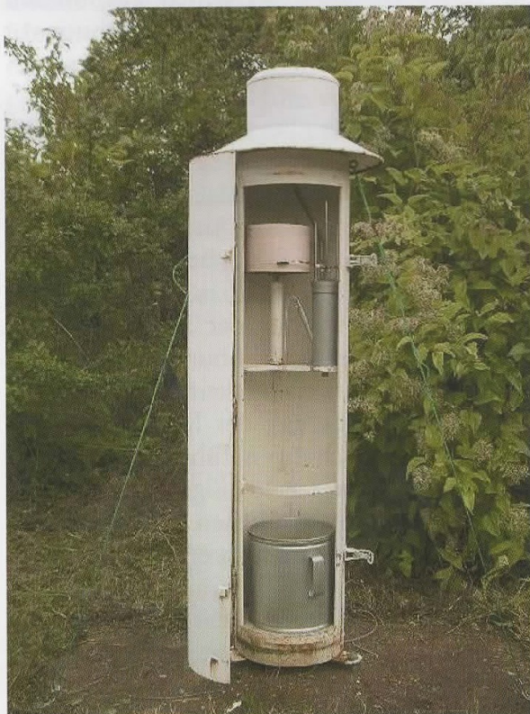
Abb. 3: Blick in einen geöffneten Hellmann-Niederschlagschreiber (links) und Ansicht eines Thermohygrographen der Firma Thies (rechts), nicht maßstäblich dargestellt.
